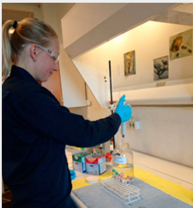
Provberedning på laboriet av vattenprov taget efter det biologiska reningssteget.
