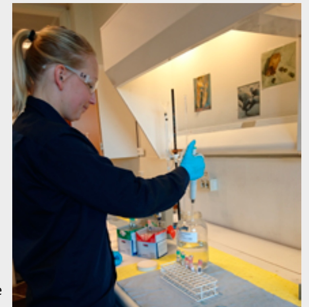
Provberedning på laboratoriet av vattenprov taget efter det biologiska reningssteget.
